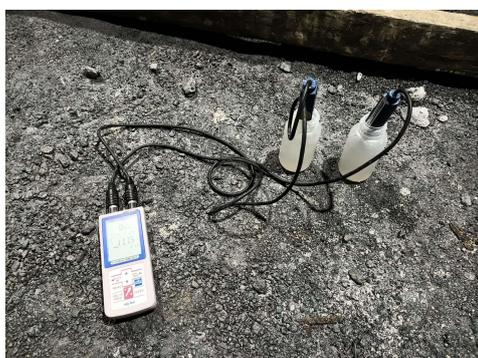
図 4 1 ボーリング湧水の水質測定
