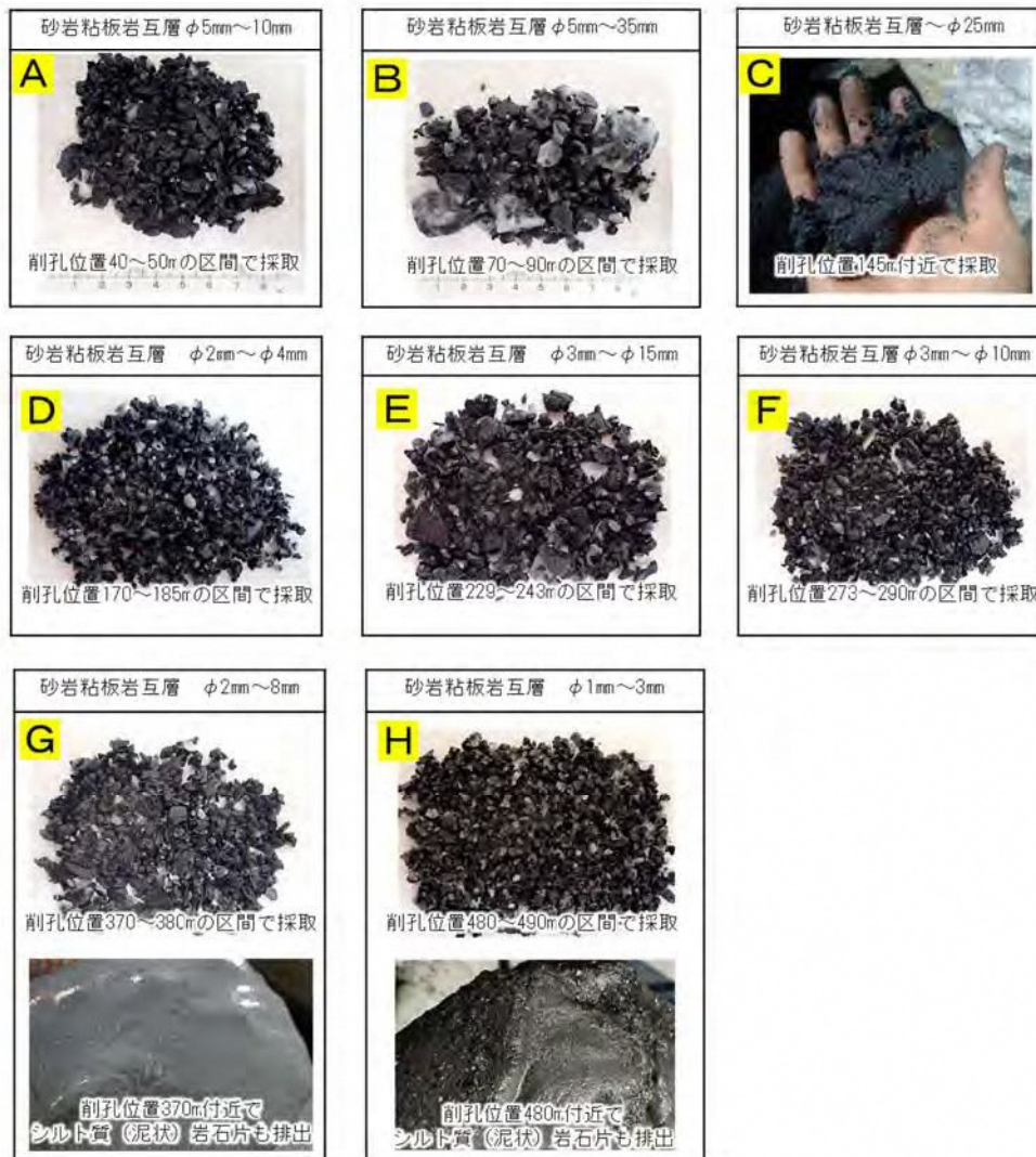
図 6 掘削エネルギー値及び代表的な岩石片 (G箇所のスライム写真を追加)
