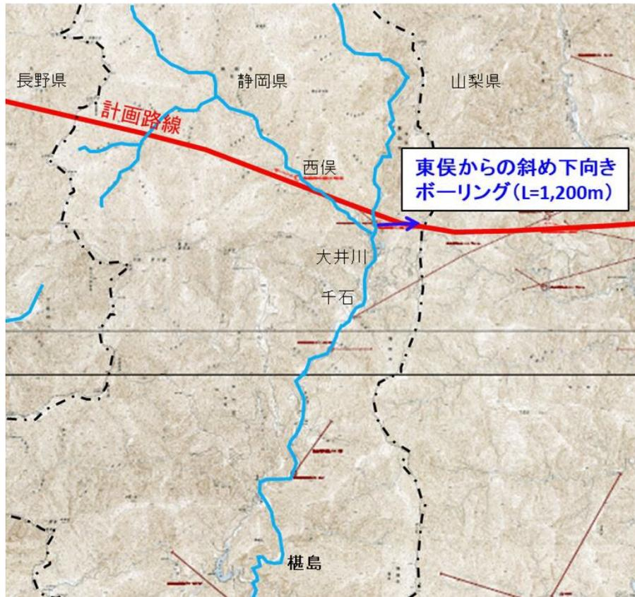
図 18 東俣からの斜め下向きボーリングの位置図
