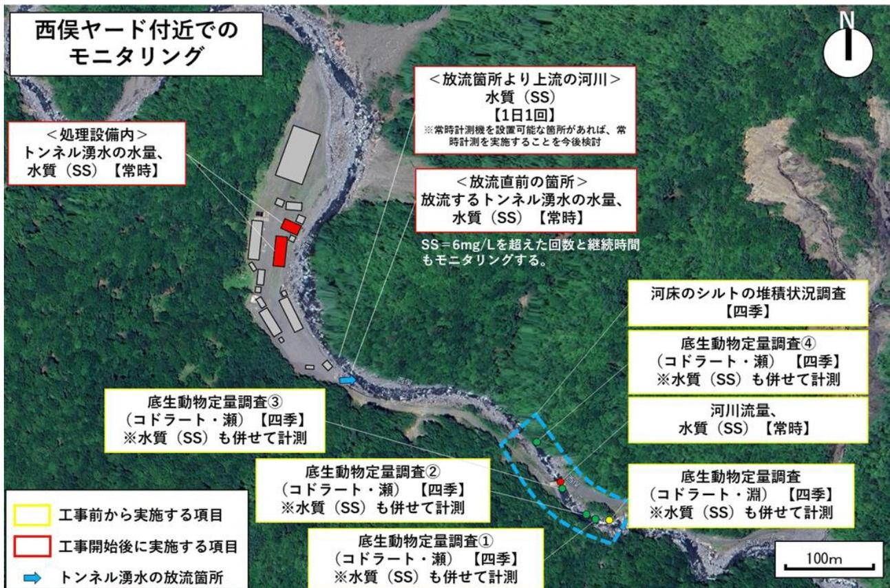
図 5 西俣ヤード付近でのモニタリング計画
