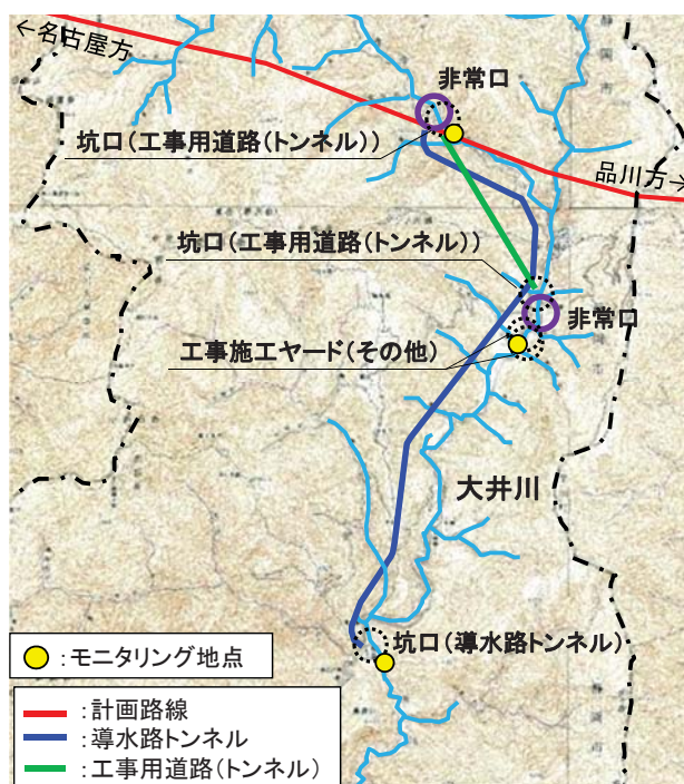
図 トンネル工事に係る水質モニタリング地点
