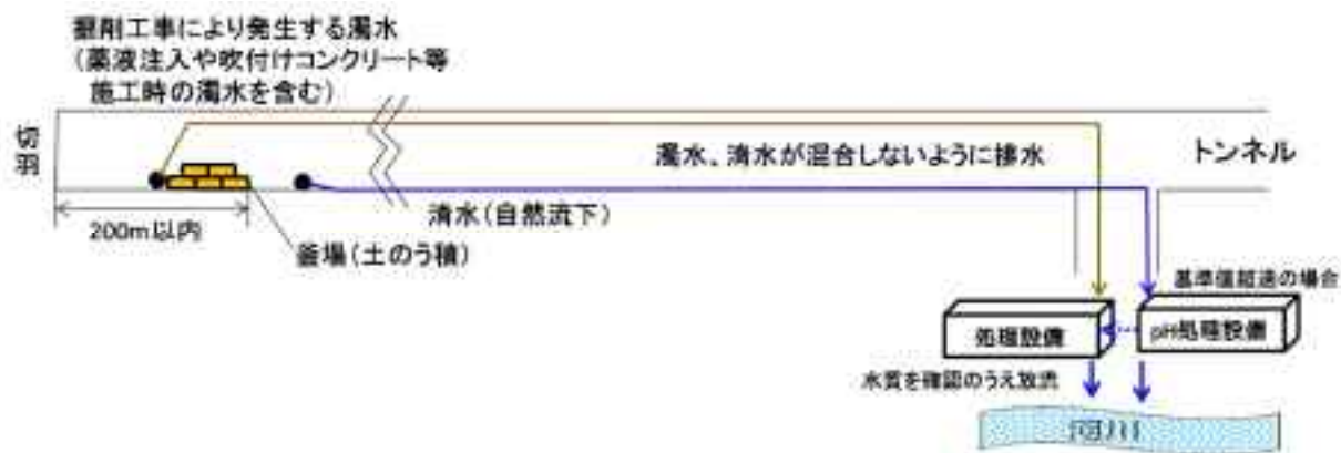
図 6.8 清濁分離処理（導水路トンネル）
