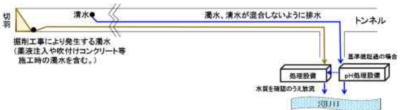
図 6.3 清濁分離処理（本坑、先進坑、斜坑）
