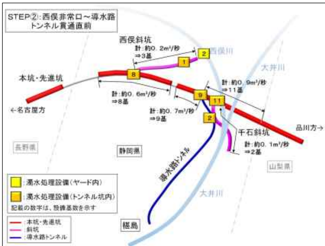
図 6.6 濁水処理設備の配置 (STEP②)
