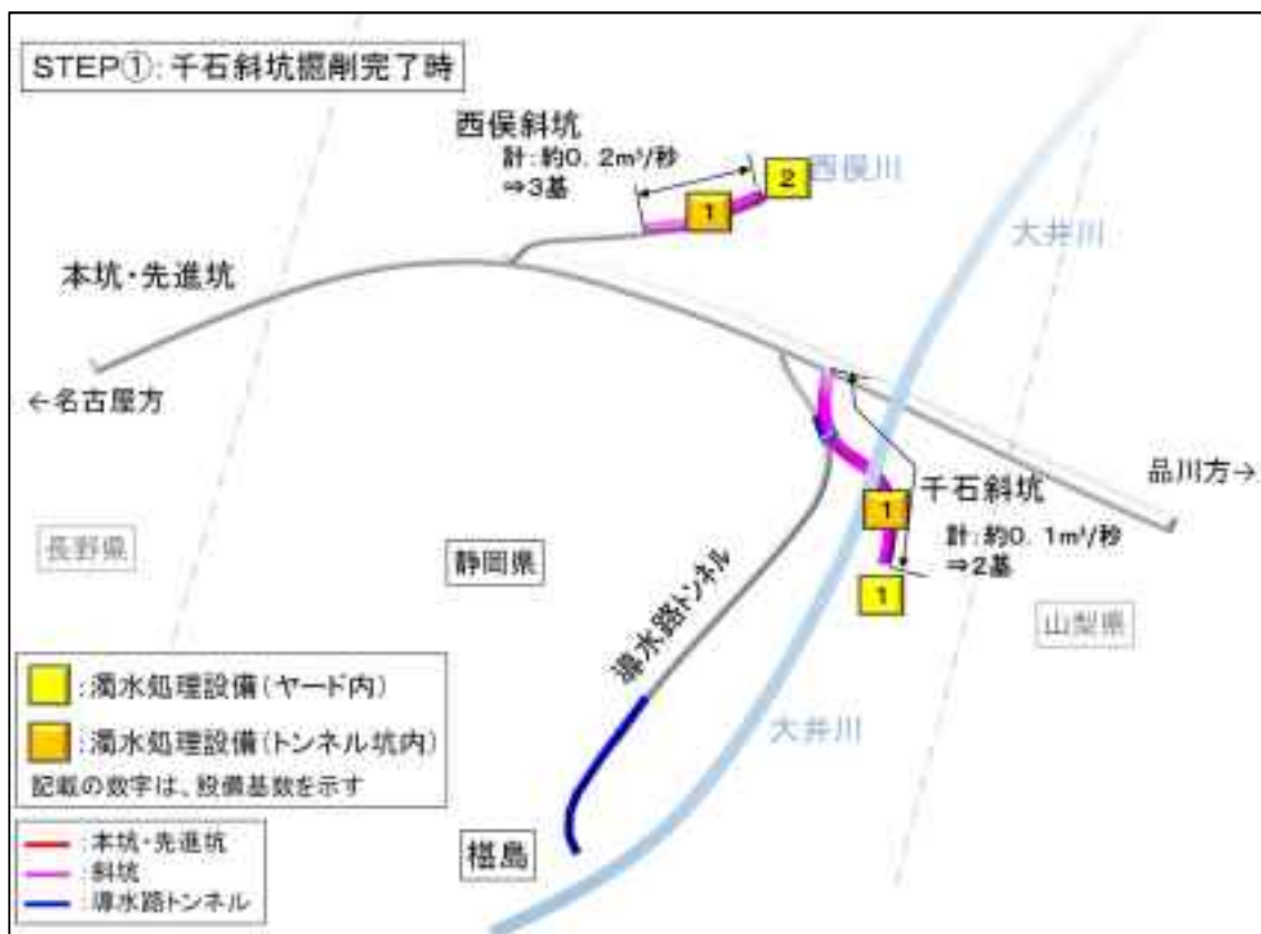
図 6.5 濁水処理設備の配置（STEP①）
