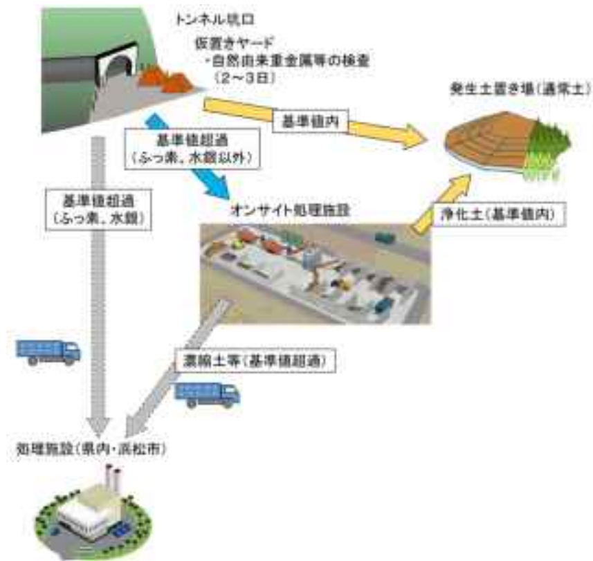
図 3.31 対策土を現地で浄化処理する場合の動き
