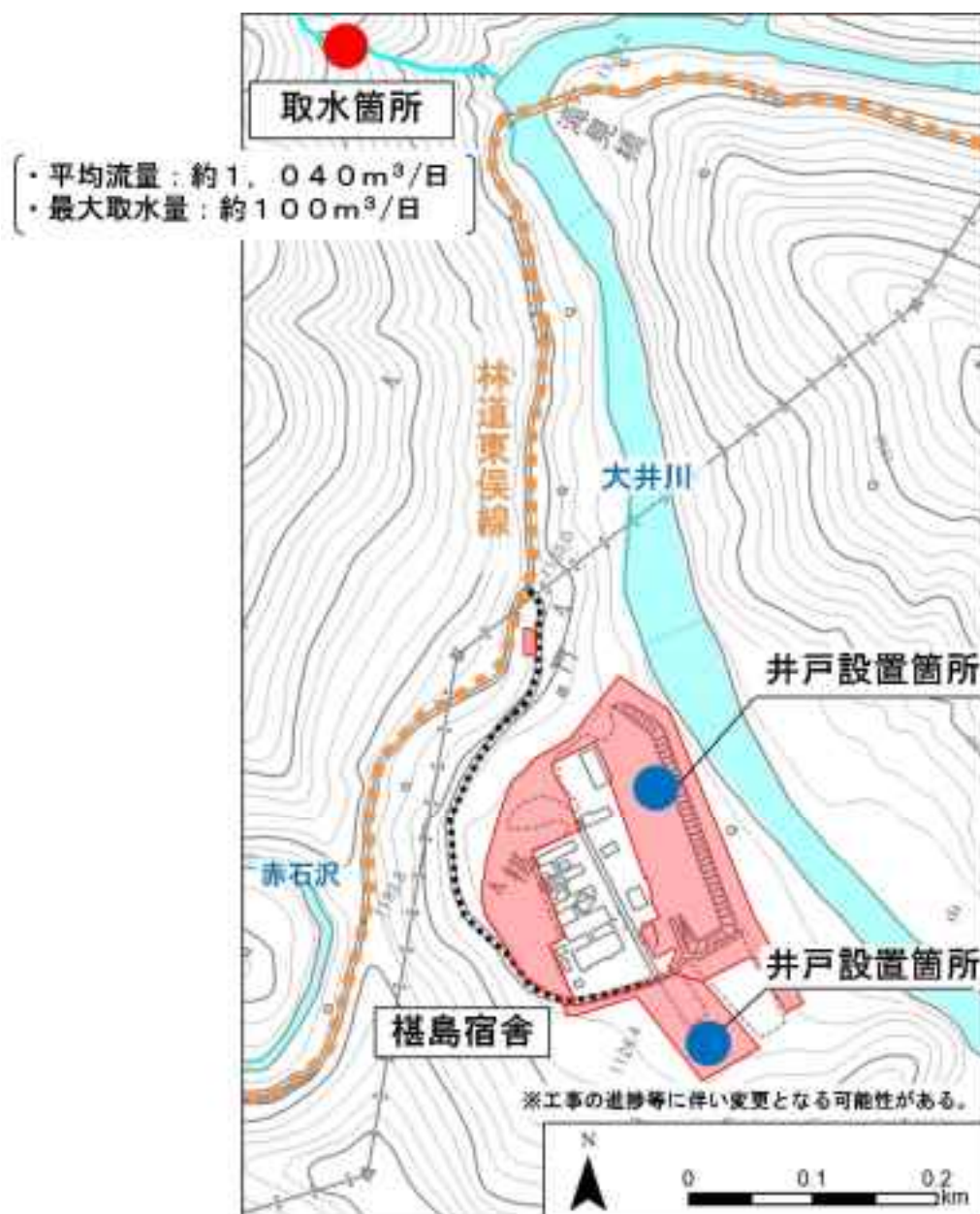
図 8.3 生活用水の取水（榎島宿舎）
