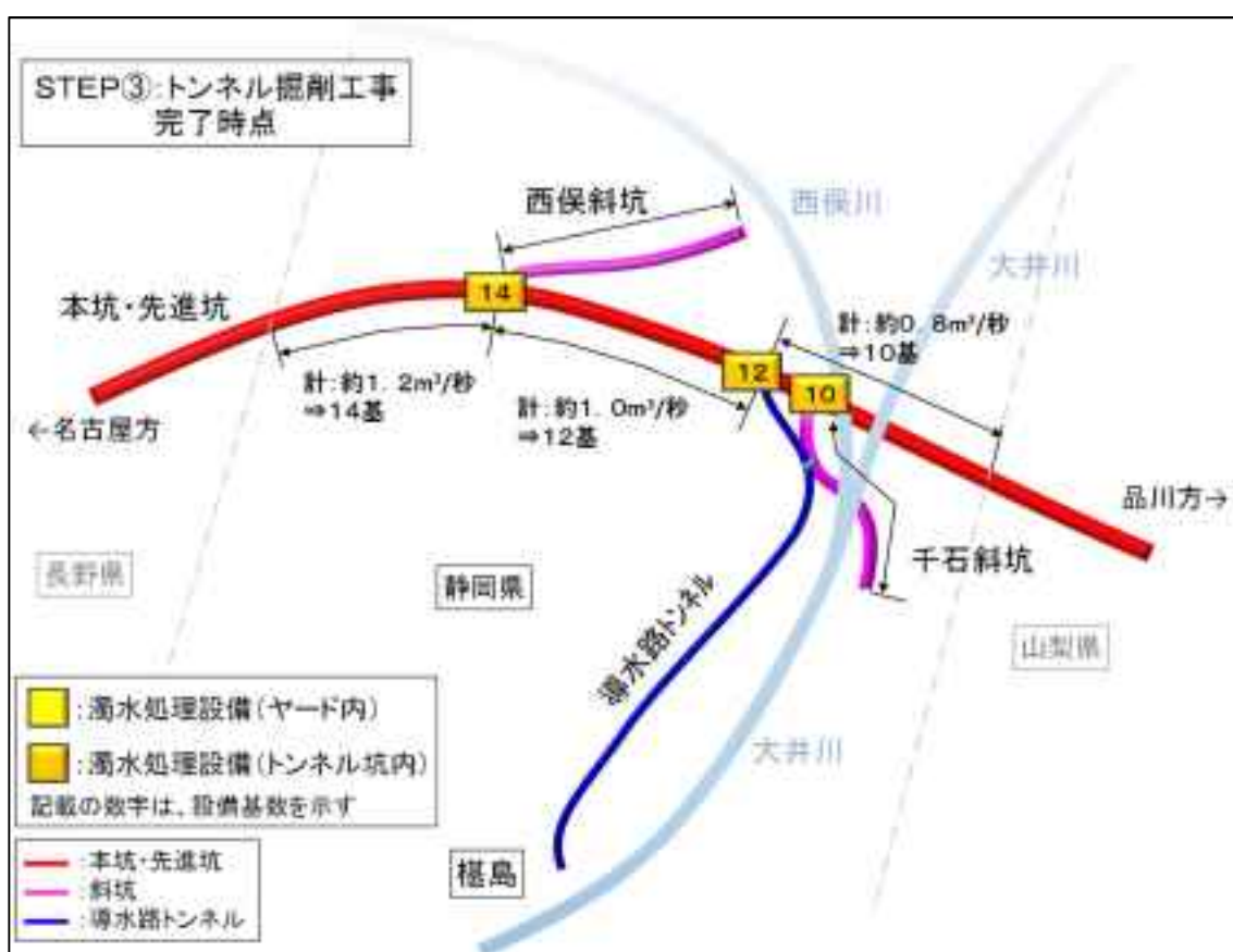
図 6.7 濁水処理設備の配置（STEP③）
