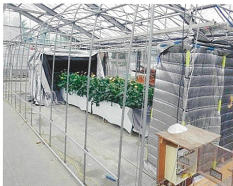
写真2 ナノファイバー多層断熱資材を展開した温室(試験2、3)
