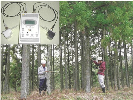
携帯型測定器による立木ヤング率調査の様子
