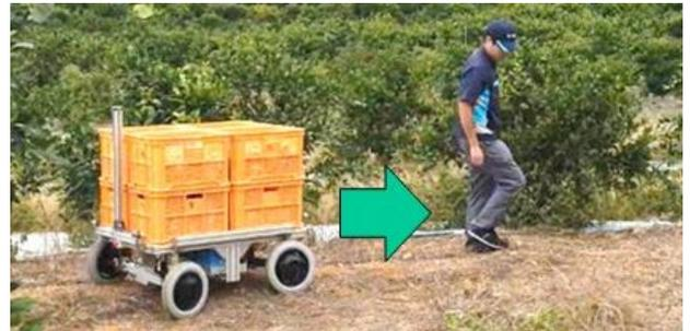
図 果樹園で作業者の後方を追従走行する運搬補助ロボット
