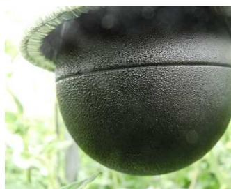
【 $\Delta T$ が $0^{\circ}\text{C}$ 以下となり結露したセンサ】
