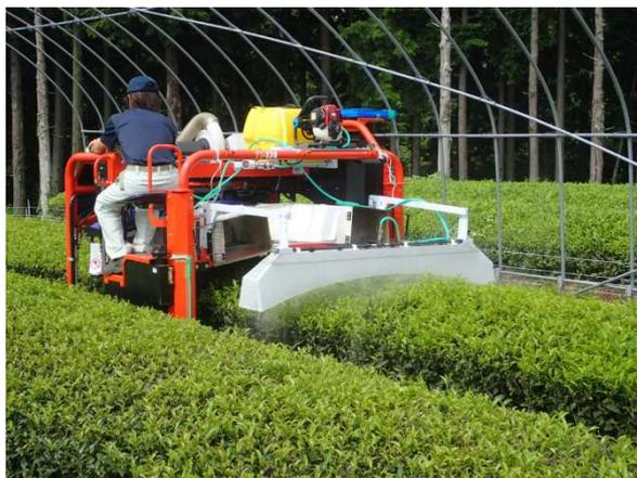
＜乗用型摘採機搭載型薬剤散布装置の輪斑病に対する防除効果＞
