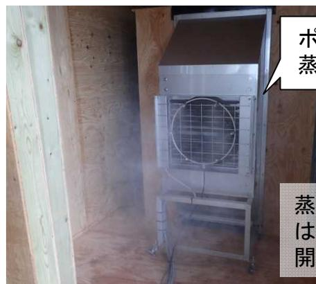
ポータブル型蒸熱処理装置
