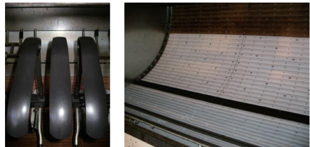
図2 フッ素樹脂加工した揉み手へら及び竹だく
