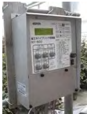
写真 2-3 試験に用いたハイブリッド制御盤 NT-600
