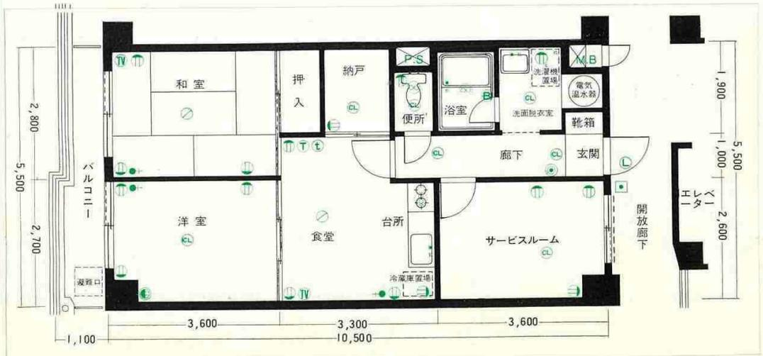
凡例 ●コンセント(2口) ●アース付コンセント ●クーラー用コンセント(200V) ●電話アウトレット ●テレビアウトレット ●非常警報ランプ ●インターホン押ボタン ●インターホン ●換気扇 ●給水栓 ●給湯栓
