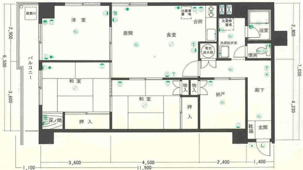
凡例: ㊦コンセント(2口) ㊦アース付コンセント ㊦クーラー用コンセント(200V) ㊦電話アクトレット ㊦テレビアクトレット ㊦非常警報ランプ ㊦インターホン押ボタン ㊦インターホン ㊦換気扇 ㊦給水栓 ㊦給湯栓
